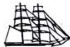
Brick - navire à deux mâts, gréé de voiles carrées, à grand-voile aurique brigantine, remplaçant la grand-voile carrée.
